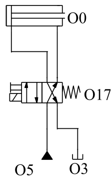
Abbildung 2.2.: Hydraulischer Schaltplan, bestehend aus Zylinder O0, Tank O3, Pumpe O5 und Ventil O17.
